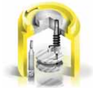
Einsatz in Ruhestellung: Schnittdarstellung des explosionsgeschützten Gehäuses
