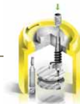
Einsatz in Ruhestellung: Schnittdarstellung des explosionsgeschützten Gehäuses
