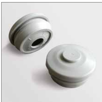
Doppelmembranstutzen IP 66, mit 2 integrierten Dichtungsmembranen, Festsitz ohne Gegenmutter, für Wandstärken 1,5 - 4,5 mm
