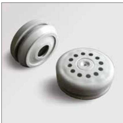
Belüftungsstopfen mit Labyrinth-Dichtung gegen Kondenswasser- bildung; IP x 4; für Wandstärken 1,5 - 4,5 mm
